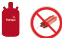
Flüssiggas-Flaschen dürfen nicht mit explosiven oder explosionsgefährlichen Gütern in einem Fahrzeug zusammen transportiert werden.
