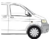
Aus ladungs- und lüftungstechnischen Gründen sind PKW für den Transport von Flüssiggasflaschen nicht besonders gut geeignet. Die Beförderung von Flüssiggasflaschen im PKW darf deshalb nur kurzzeitig erfolgen. Eine ausreichende Belüftung des PKW liegt vor, wenn das Lüftungsgebläse auf höchster Stufe eingestellt ist und die Fenster geöffnet sind.
